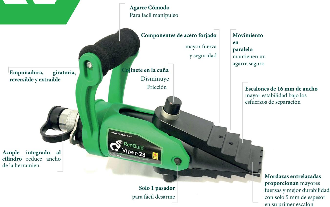
La cuña Viper-28M de RenQuipes la herramienta más avanzada para separar conjuntos de bridas. Requiere solo un espacio de 5 mm entre las caras de la brida y produce fuerza de separación de 27,7 T por herramienta, y pesa solo 5 kg
